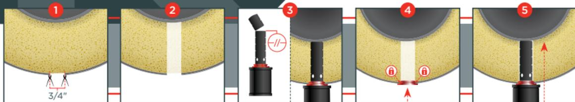
**PASO 1** Cortar/perforar un agujero de 3/4" en la ubicación deseada en el revestimiento utilizando tijeras de hojalatero o una sierra de agujeros, *asegurarse de que la sierra de agujeros sólo penetra en el revestimiento*
